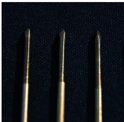
Рисунок 14 – Элементы фиксации экзоскелета с наружной резьбовой нарезкой на остром конце
