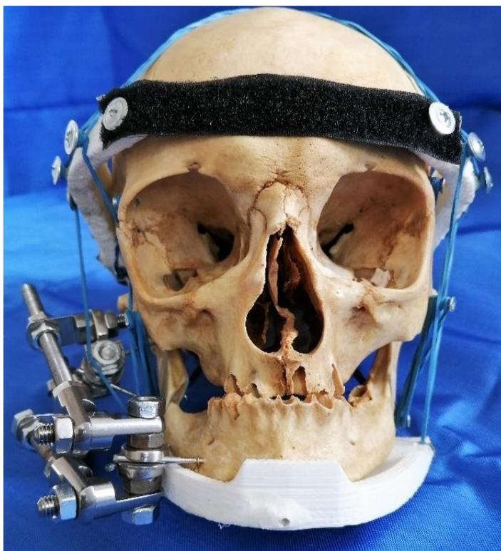
Рисунок 16 – Собранная экспериментальная модель экзоскелета
